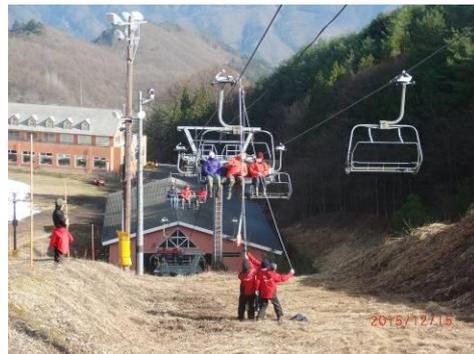
※ナイター時停電への取り組みとして、非常用発電装置、予備原動装置(非常用リフト運転装置)取扱い訓練を実施致しました。
